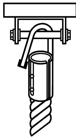
Лопнул сварной шов крепления каната
